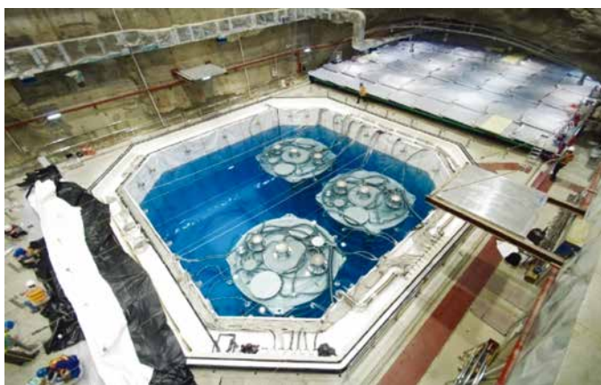
远点实验大厅俯视图3个中微子探测器置于水切伦科夫探测器水池中，远端可见阻性板探测器
