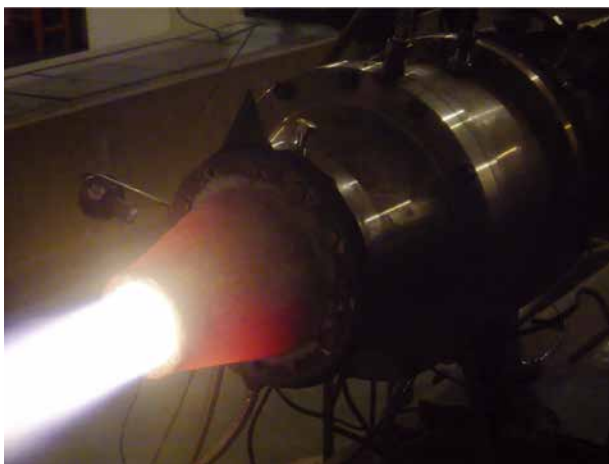
涂层在 1600℃ 燃气风洞冲刷环境
