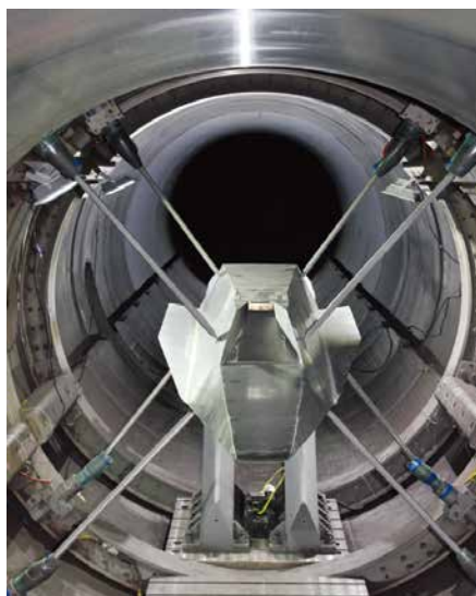
国际首次复现高超声速飞行条件下飞行器带动力一体化实验
