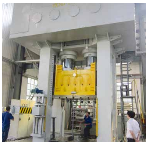
多工位压力机调试现场
