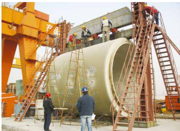
复杂水工混凝土PCCP服役性态原型诊断试验
